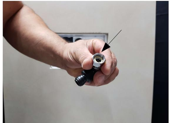
5. Dichtung in den Überwurf einlegen
