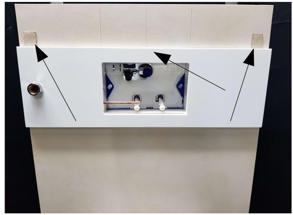
19. Platte an die Markierung in der Mitte und an den Montagepunkten ansetzen und 10 sek fest an die wand drücken und gedrückt halten.
